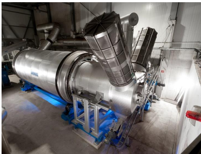
Slika 24: Reaktor za torefikacijo pri proizvodnji biopremoga.
